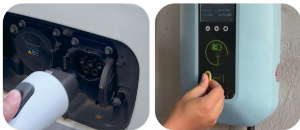
Рис. 6. Подключение коннектора и запуск зарядки
