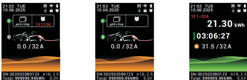
Рис. 4. Экраны при запуске зарядной сессии: режим резервирования, ожидание ответа автомобиля, режим зарядки
